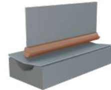
6 Предварительная формовка трубной заготовки
