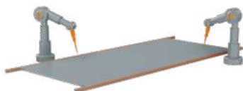
11 Сварка наружного шва
