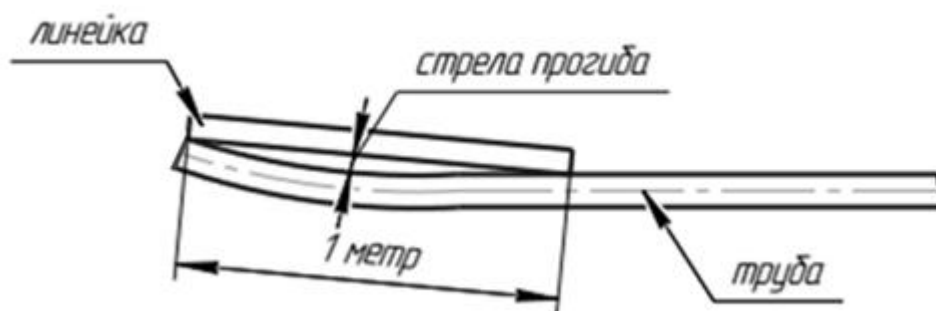
Рисунок 3 – Схема контроля прямолинейности концевых участков трубы
