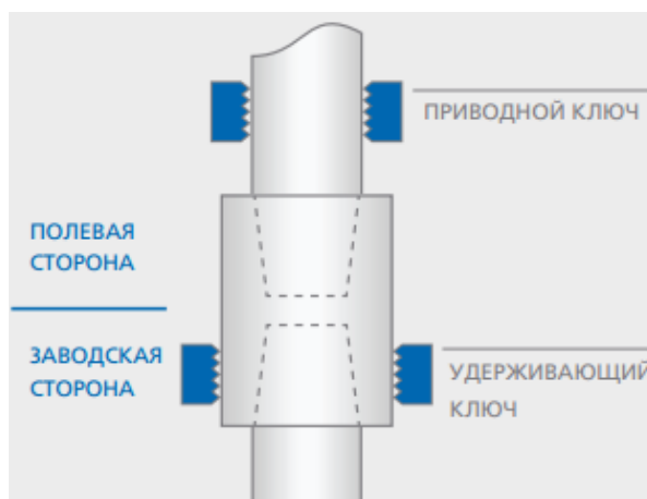
Рисунок 7 – Положение ключей при развинчивании
