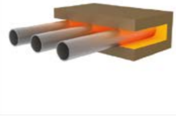
2 Индукционный нагрев концов труб
