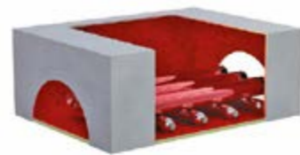
в Отпуск проводится в газовой печи
