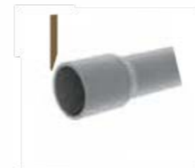
11 Термическая обработка зоны сварного соединения
